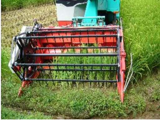
(写真5) ダイレクトカットユニット
