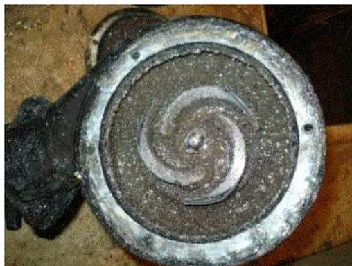
図2 ポンプ内全面に付着した結晶化物
