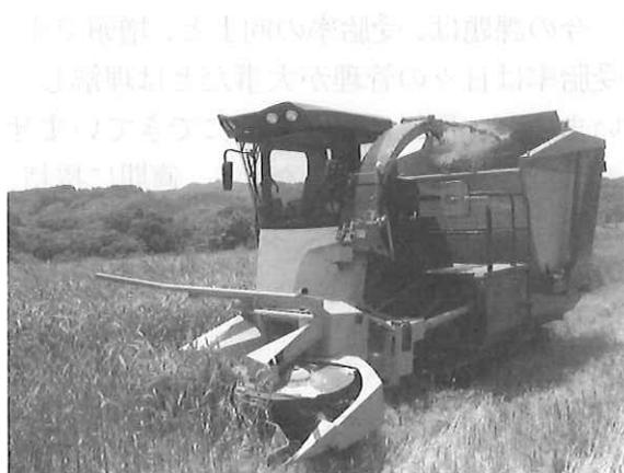
微細断型収穫機によるライ小麦の収穫
