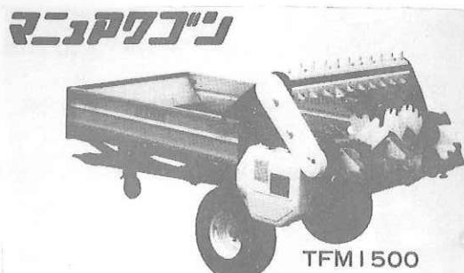
大型メインビータとスパイク型ならしビータの2段方式で堆肥を細かく破碎して均一散布床コンベヤは散布ムラがなく音の静かな連続送り方式
